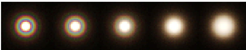
Abbildung 1.3: Von Links nach rechts: Beugungsbild eines Sternes der Spektralklasse G, \sigma = 0, 1/4 a, 1/2 a, a und 3/2 a . Die Sternabbilder sind in guter Übereinstimmung mit den Aussagen in Tab. 1.1. Die Abbildung ist linear aufgehellt, damit die Überlagerung der Beugungsringe erkennbar wird.
